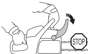
**Фиксатор на дроселната клапа**
