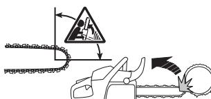
Обратният тласък е винаги в посока на шината. Обикновено верижният трион и шината се отхвърлят назад и нагоре, по посока на оператора. Но верижният трион може да отскочи и в други посоки в зависимост от положението си в момента, когато рисковият сектор на шината се допре до някакъв предмет.
