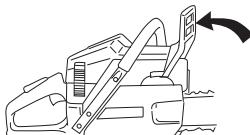
Отвинтете гайките на шината и свалете капака на съединителя. Свалете защитата за транспортиране (A).
