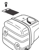
Ауспухът е предназначен за намаляване равнището на шума и насочване на отработените газове встрани от оператора. Отработените газове са нагрети и могат да съдържат искири, които да предизвикват пожар, когато попаднат върху сух и горлив материал.
