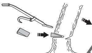
Пропоръчваме ви да използвате шина, която е по-дълга от диаметъра на дървото, така че да можете да правите основния срез и насочващите срезове с "единични режещи движения". Вижте инструкциите в раздела със заглавието Технически данни относно, как дължини на шината се препоръчват за вашия модел моторен трион.
