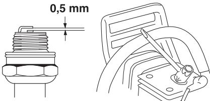
**ЗАБЕЛЕЖКА!** Използвайте винаги запалителните свещи от препоръчания вид! Използването на погрешен тип свещи може да предизвика сериозни повреди на буталото/цилиндъра. Убедете се, че запалителната свещ е снабдена със защита от радиосмущения.
