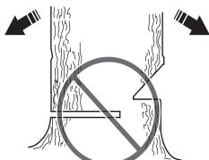
След завършване на поваляния срез и направляващия срез дървото трябва да започне да пада под въздействието на собствената си тежест или с помощта на клин или лост.
